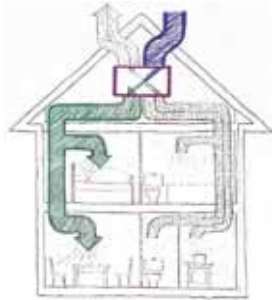
Das Prinzip der mechanischen Wohnungslüftung mit Wärmerückgewinnung
