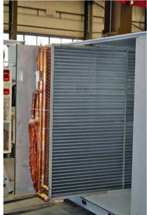
Abb. 9: Ein Wärmetauscher, der zur Erwärmung oder Kühlung von Luft eingesetzt wird
